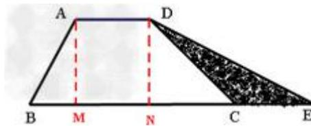
(1) 已知需加固的大坝长为 150 米，求需要填土石方多少立方米？
