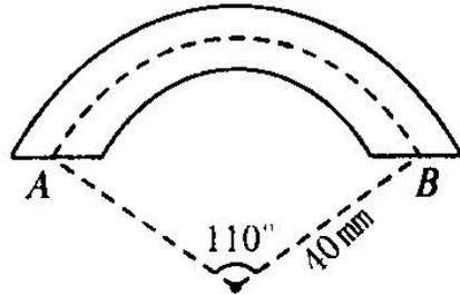
分析：要求管道的展直长度，即求弧 AB 的长，根据弧长公式  $l = \frac{n\pi R}{180}$  可求得弧 AB 的长，其中  $n$  为圆心角， $R$  为半径.
